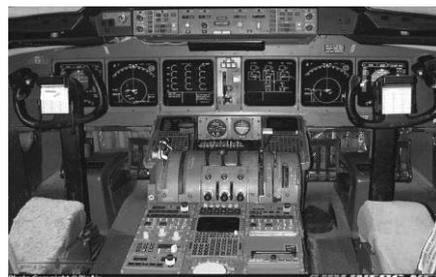
*Figuras 1 e 2- Antigo cockpit ainda com posto de engenheiro de voo (Constalation) e pouca automação. A cognição distribuída era limitada. Abaixo, o novo Boeing 777- pilotos e computadores : Dois pilotos apenas e mais distribuição das tarefas entre computadores e humanos.*
