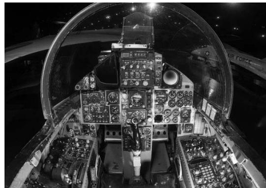
Figura. 2- A complexa interface de controle de avião de combate (foto autorizada no site <https://www.novos+cockpits+na+aviamilitar&client> em 2018)
