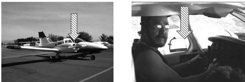
Figuras 7 e 8 - O avião Piper Seneca em terra e em voo e a única porta de saída dos pilotos A seta à esquerda indica a porta. A seta à esquerda a ausência de uma porta no lado do piloto. (fotos do autor)
