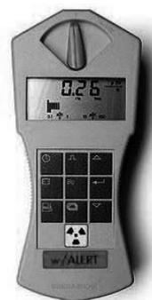
Figura 2 - Detetor de radiação gama GAMMA SCOUT®.
