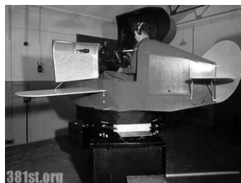
Figura 2- O Treinador de Link foi um grande sucesso em diversos países, entre eles Japão, onde foi vendido a uma companhia aérea, a Army Air Corps . No começo da Segunda Guerra Mundial, os pilotos utilizavam instrumentos em Links ou derivados.
