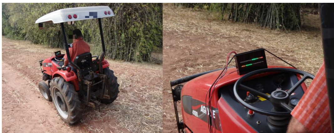
Figura 2 – Dispositivo pronto e enclausurado com um sinal de alerta, fixo no painel de um trator, em região de perigo.
