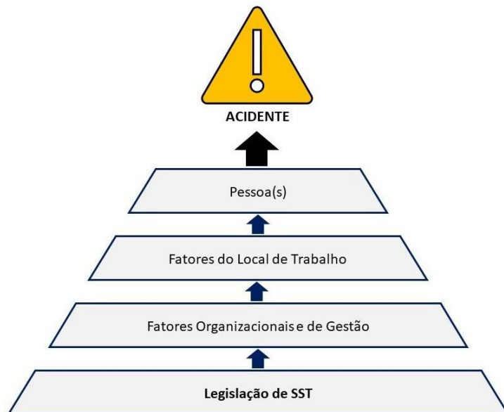
Figura 4. Modelo de acidente subjacente à Parte II do processo RIAAT (Jacinto et al. (2010) – adaptado de Reason (1997))
