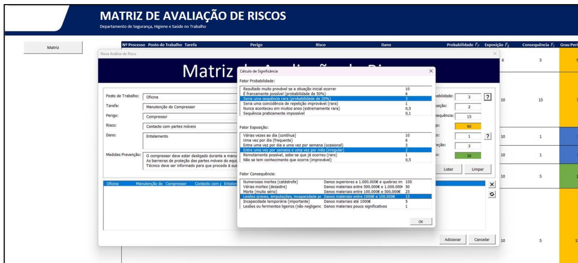
Figura 13. Formulário de Utilizador em Excel para Identificação de Perigos e Avaliação de Riscos, preenchido, pop-up
