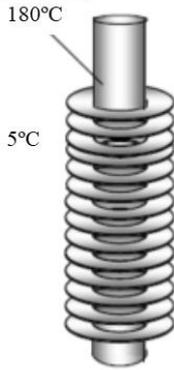
Para aproveitar o calor de uma tubagem de vapor vão ser colocadas alhetas circulares com 60 mm de diâmetro e espessura de 1 mm em tubos de 50 mm de diâmetro. As alhetas são em liga de alumínio ( $k=186 \text{ W/mK}$ ) e a superfície exterior dos tubos pode considerar-se à temperatura do vapor, de  $180^\circ\text{C}$ . O ambiente exterior está a  $25^\circ\text{C}$ , e o coeficiente de transferência exterior é de  $40 \text{ W/m}^2\text{K}$ .
