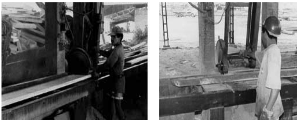
Figura 2: Destopadeira usada para cortes transversais da madeira. Fonte: Fundacentro/Pa.
