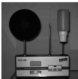
Figura 1 – Termômetro de globo negro padrão
