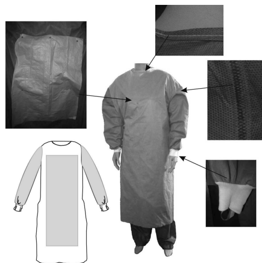
Figura 3. 3 – Descrição da bata de uso único reforçada (B2)
