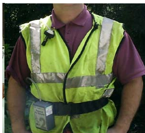
Figura 1 - Colocação do equipamento de amostragem 7 Fonte - The European Network on Silica. 2006.
