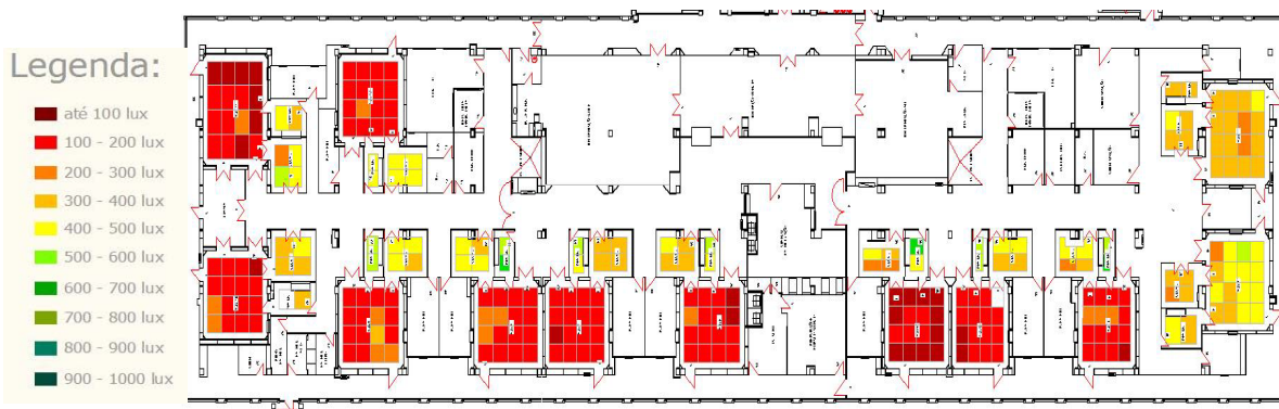
Figura 1 – Representação dos valores médios de iluminação, através de uma escala de cores na Planta do B.O.C.
