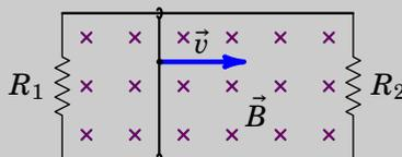
**Resolução.** O produto vetorial  $\vec{v} \times \vec{B}$  tem módulo igual a  $vB$  e aponta na direção tangente à barra. Como tal, usando a equação (9.7), a f.e.m. induzida na barra é igual a:
