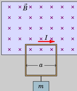
**Resolução.** Usando a equação (7.40) para fios retilíneos, a força magnética na aresta de comprimento  $a$  dentro do campo aponta para cima e tem módulo,
