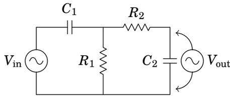
(a) Demonstre que a função de resposta em frequência é a expressão na equação (10.38), onde  $G = R_2/R_1$ ,  $\omega_1 = 1/(R_1 C_1)$  e  $\omega_2 = 1/(R_2 C_2)$  (sugestão: use as expressões  $Z_1 = R_1 \omega_1/s$  e  $Z_2 = R_2 \omega_2/s$  para as impedâncias dos dois condensadores e no fim substitua  $s$  por  $i\omega$ ).
