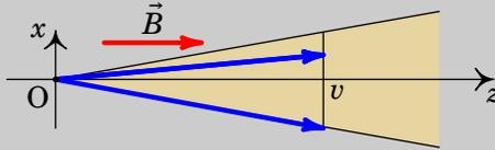
**Resolução.** Dependendo da componente perpendicular da velocidade, as partículas seguem por hélices diferentes. Mas como a frequência angular de ciclotrão (equação (7.8)) não depende da velocidade, todas as partículas rodam nas hélices com a mesma frequência e o mesmo período:
