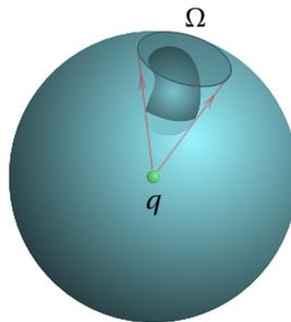
**Figura 2.12.:** Carga pontual fora de uma superfície fechada.
