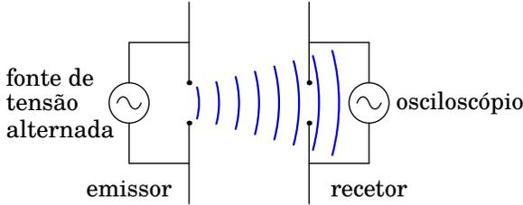
**Figura 12.6.:** Produção e detecção de uma onda eletromagnética.
