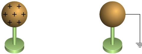
**Figura 1.5.:** Objeto condutor a ser descarregado usando uma ligação à terra.
