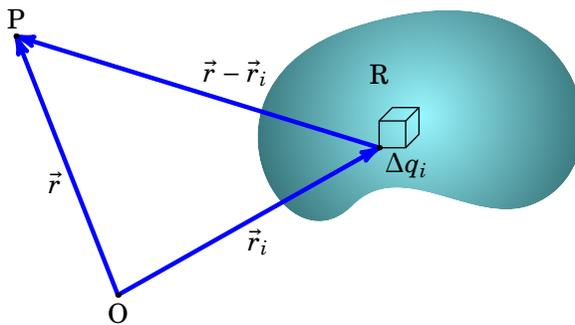
**Figura 2.2.:** Carga distribuída numa região e uma pequena sub-região com carga  $\Delta q_i$ .
