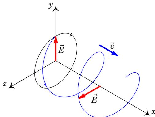
**Figura 11.9.:** Onda eletromagnética com polarização circular direita.
