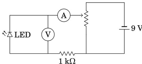
**Figura 12.13.:** Circuito usado para determinar a característica de um LED.
