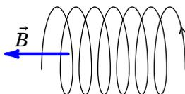
**Figura 7.5.:** Movimento ao longo de uma hélice, em que há campo magnético uniforme e não há campo elétrico.
