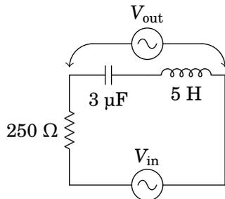
**10.6.** No circuito representado no diagrama, determine a potência média fornecida pela fonte, sabendo que esta tem frequência de 30 Hz e voltagem máxima de 9 V.
