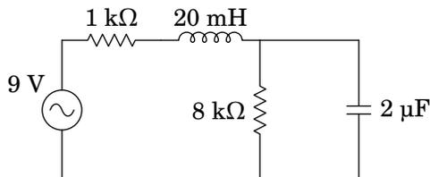
**10.7.** No filtro de frequências representado no diagrama, o sinal de entrada é a tensão  $V_e$  de uma fonte de tensão alternada, com frequência angular  $\omega$ , e o sinal de saída é a tensão  $V$  medida no condensador, como indica a figura. Encontre a expressão da função de resposta em frequência, em função de  $\omega$ .
