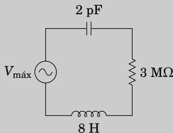
**Resolução.** Com a resistência em  $M\Omega$  e a capacidade em  $pF$ , convém usar  $\mu s$  para a unidade de tempo e, portanto,  $MHz$  para a frequência e  $H$  para a indutância.
