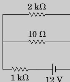
as resistências de  $2 \text{ k}\Omega$  e  $10 \Omega$  estão em paralelo, podendo ser substituídas por uma única resistência com valor  $2000 \parallel 10 = 2/201 \text{ k}\Omega$ , que fica em série com a resistência de  $1 \text{ k}\Omega$  e a resistência equivalente entre os terminais da fonte é
