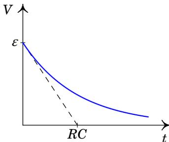
**Figura 6.16.:** Tensão em função do tempo no circuito RC.
