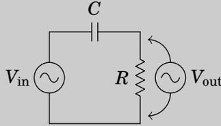
**Resolução.** A impedância da resistência é  $R$  e a impedância do condensador é  $1/(Cs)$ , onde  $s = i\omega$ . Pela lei de divisão de voltagem, o fasor da tensão de saída é igual a:
