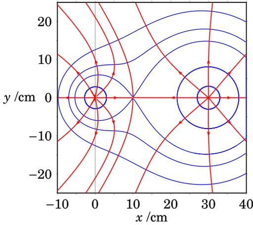
**Figura 3.4.:** Curvas equipotenciais (a azul) e linhas de campo (a vermelho) de duas cargas pontuais de  $+1 \text{ nC}$  e  $+4 \text{ nC}$  afastadas  $30 \text{ cm}$ .
