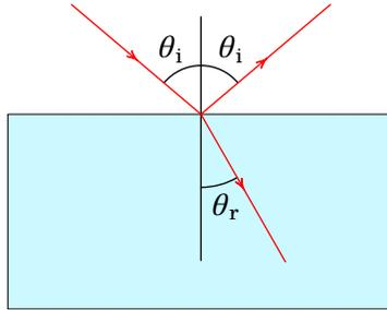
**Figura 12.1.:** Reflexão e refração de um raio de luz numa barra de vidro.
