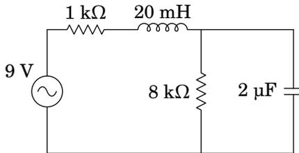
**10.15.** No filtro de frequências representado no diagrama, o sinal de entrada é a tensão  $V_{in}$  de uma fonte de tensão alternada, com frequência angular  $\omega$ , e o sinal de saída é a tensão  $V_{out}$  medida no condensador, como indica a figura. Encontre a expressão da função de resposta em frequência, em função de  $\omega$ .
