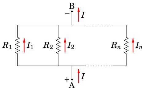
**Figura 6.9.:** Divisão de corrente entre várias resistências.
