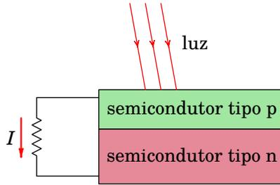
**Figura 12.8.:** Célula fotovoltaica.
