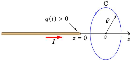
**Figura 11.1.:** Fio retilíneo no semieixo negativo  $z$ , com corrente  $I$ .
