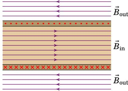
**Figura 8.11.:** Campo magnético num solenoide infinito.
