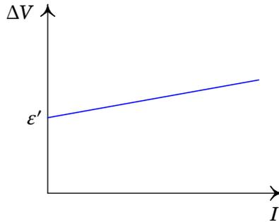
**Figura 12.12.:** Característica tensão-corrente de um LED.
