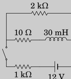
**Resolução.** Como antes de ser fechado o interruptor não passa corrente pelo indutor, no instante inicial o indutor é equivalente a um interruptor aberto, ou seja, não circula corrente pela resistência de  $10 \Omega$  e é como se essa resistência e o indutor não existissem. Ignorando esses dois elementos, o circuito corresponde a uma única malha com a fonte e as duas resistências de  $1 \text{ k}\Omega$  e  $2 \text{ k}\Omega$  em série. Nesse instante, a corrente nessas duas resistências é:
