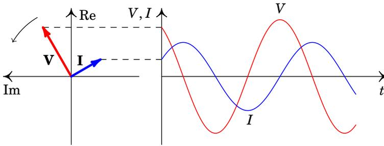
**Figura 10.8.:** Fasores da tensão e da corrente num indutor.
