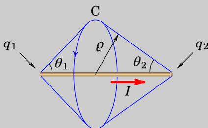
Aplicando a lei de Ampère-Maxwell, obtém-se mesma expressão (11.3) para o módulo do campo. A corrente no fio finito implica acumulação de cargas,  $q_1$  e  $q_2$ , nos dois extremos, com derivadas:
