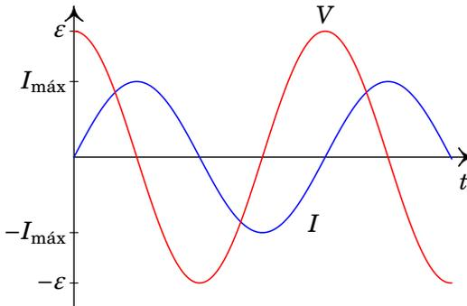
**Figura 10.2.:** Tensão e corrente e no circuito LC da figura 10.1.
