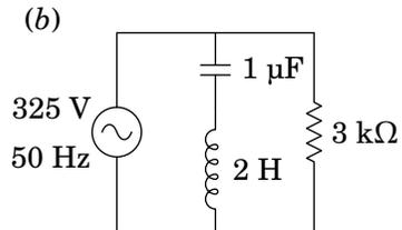
**10.3.** A figura mostra um filtro *rejeita-banda* que atenua as frequências angulares próximas de  $1 \text{ kHz}$ .
