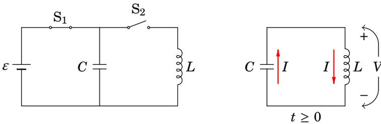
**Figura 10.1.:** Circuito LC, em  $t < 0$  (lado esquerdo) e circuito equivalente para  $t \geq 0$  (lado direito) em que  $S_1$  está aberto e  $S_2$  fechado.
