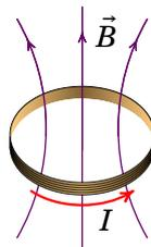
**Figura 9.6.:** Campo magnético produzido pela corrente numa bobina.
