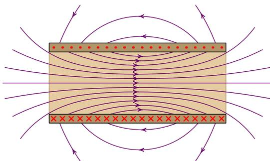
**Figura 8.10.:** Campo magnético produzido por um solenoide.
