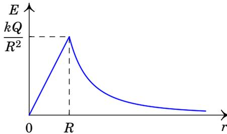
**Figura 2.13.:** Campo elétrico de uma esfera de raio  $R$  e carga  $Q$ , com densidade de carga constante (no caso em que  $Q > 0$ ).
