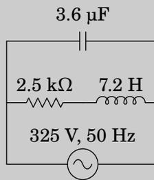
**Resolução.** Usando unidades de  $\text{k}\Omega$  para as impedâncias e  $\mu\text{F}$  para as capacidades, teremos então de usar  $\text{ms}$  como unidade de tempo e  $\text{H}$  como unidade de indutância. Usando  $\text{V}$  para as tensões, as correntes estarão em  $\text{mA}$ . A frequência angular da fonte é:  $\omega = 2 \times \pi \times 50 \text{ Hz}$ , mas como deve ser convertida para  $\text{kHz}$ , tem o valor  $\pi/10$ .
