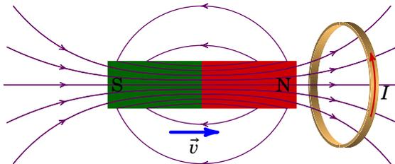
**Figura 9.4.:** Ímã em movimento junto de uma espira condutora.
