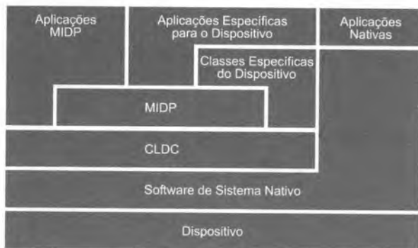
Figura 3.1 | Arquitectura de um dispositivo MIDP.
