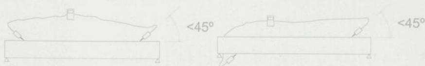
Figura 5: Medição indirecta, à esquerda, paralela, e à direita, cruzada
