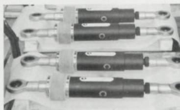
Figura 8:Exemplo dos dissipadores viscosos utilizados neste estudo [8]
