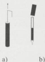
Figura 1: Exemplo de cápsulas emissora e receptora: a) Cápsula emissora capilar com dispositivo de emissão ajustável, b) Cápsula receptora com adsorvente (carvão poroso).
