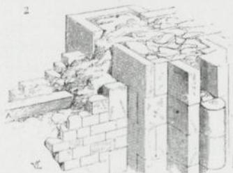
Figura 1: Esquema de parede constituída por panos de pedra e núcleo central à base de terra (E. Viollet-le-Duc, Dictionnaire Raisonée de l'Architecture).
