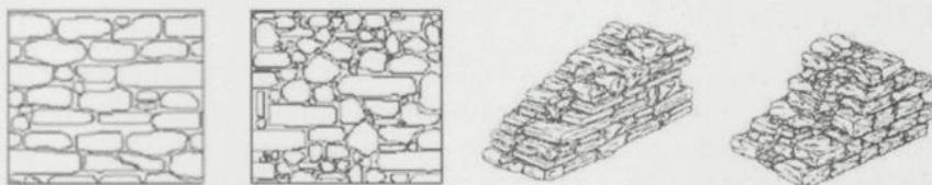
Figura 4: Tipo de assentamento, aparelho e secção transversal [3, 4]
