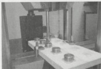
Figura 2: Provete para ensaio de arrancamento por tracção
