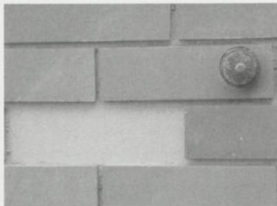
Figura 3: Peça metálica usada nos ensaios de arrancamento.
