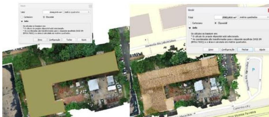
Figura 8: Cálculo de área pela identificação orthofoto x nuvem de pontos.
