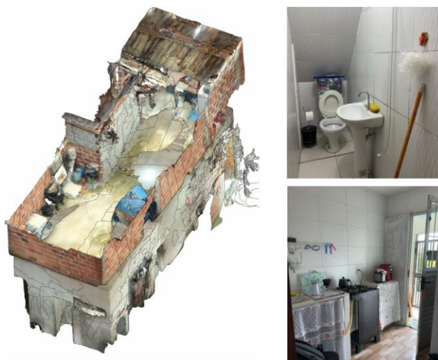
Figura 4: Levantamento, nuvem de pontos e registros vídeo-fotográficos do caso de exemplo.
