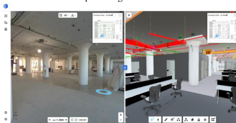
Figura 1: Interface da plataforma OpenSpace com comparação entre imagem do estaleiro (as-built) e modelo BIM (as-designed).
