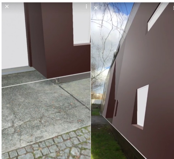
Figura 3 - Ajuste manual da ancoragem do modelo (esquerda); Modelo Virtual posicionado no modelo real (direita).
