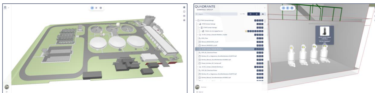
Figura 4: Interface da plataforma com o modelo digital da ETAR. Na imagem da direita observa-se a árvore IFC com a documentação e series de dados associados a cada nó, bem como a identificação dos equipamentos monitorizados (bombas) no modelo 3D.
