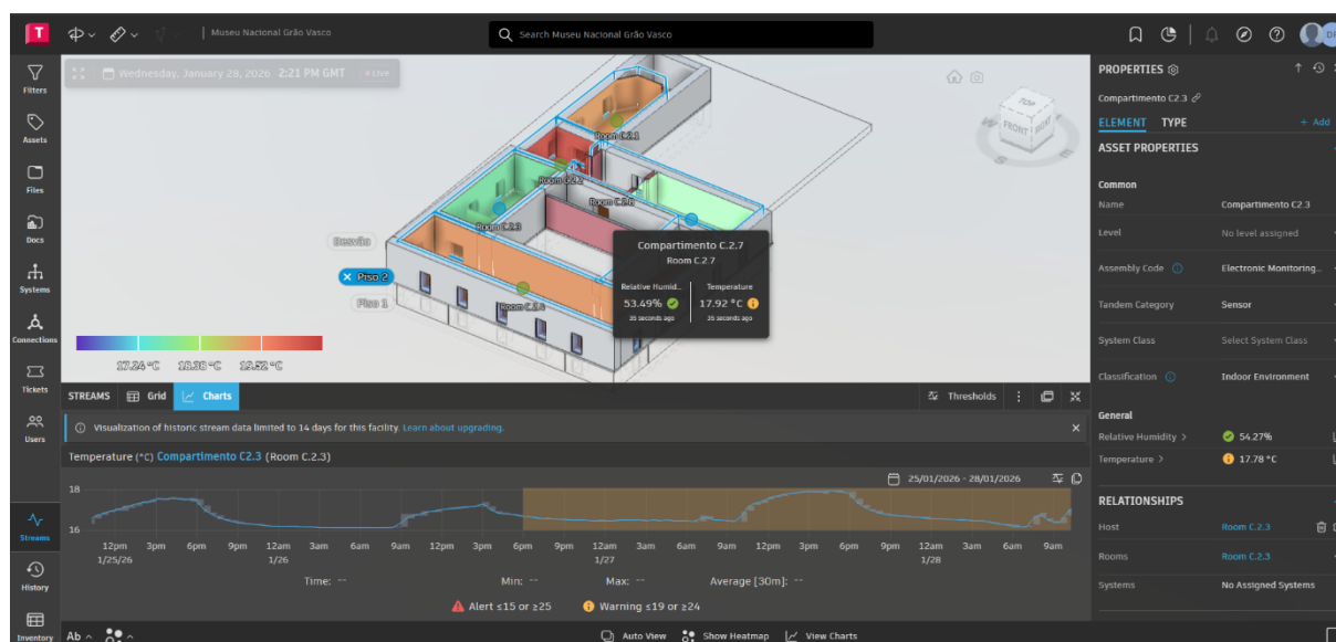
Figura 5: Interface do modelo 3D para o piso 2: mapa térmico ( heat map ) de temperatura em tempo real, painel de propriedades do compartimento e classificação por intervalos/níveis de risco térmico.
