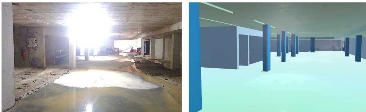
Figura 5: Sobreposição do modelo BIM de Estruturas.
