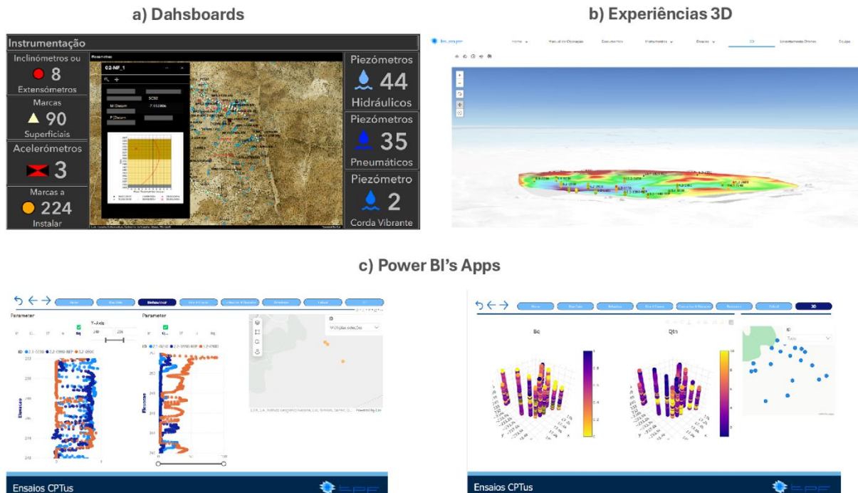
Figura 2: Ilustração de páginas da PGI – a) Dashboard da instrumentação; b) Ilustração da topografia primitiva e ensaios CPTu em ambiente 3D; c) Relatório Power BI embebido na aplicação com tratamento analítico de CPTus.
